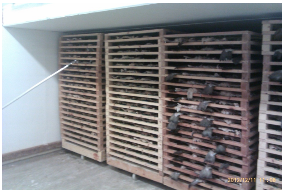
Figur 5: Tverrsnitt i tunnel. Vognene fyller tunnelen godt, slik at lite falskluft går gjennom tunnelen.
